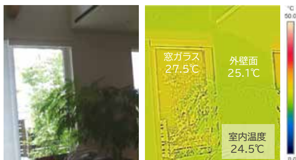
南西側外壁及び窓面のサーモ画像（8月中旬 11:30）
