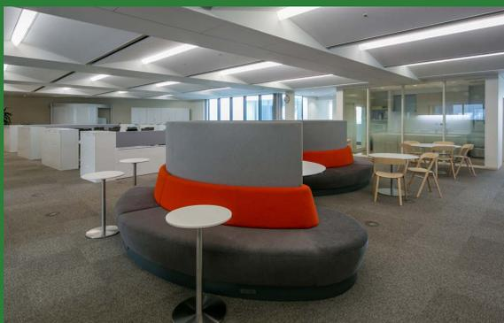
2階にあるダイニング。設定照度を通常オフィスより下げて運用しているが、折り上げ天井の頂部に設置されたアクリルパネルにより天井全体を明るくし、空間の明るさ感を確保している。天井にはセンサーが設置されており、1階の中央監視室とつないで制御している。具体的には人感センサーによる在不在制御、明るさセンサーによる適正照度制御・昼光連動制御、タイムスケジュール制御などがあり、各階を3ブロックに分けて、それぞれのセンサーで制御している。空調は床面より吹き出し、天井面への器具の取付けをなくし、天井の明るさ感を確保している。
