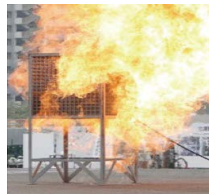
カセットコンロ用 ガス缶燃焼破裂実験
