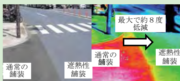
遮熱性舗装による路面温度低減効果
