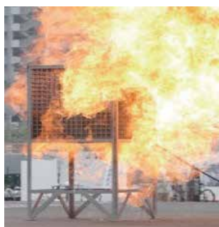
カセットコンロ用ガス缶 燃焼破裂実験
