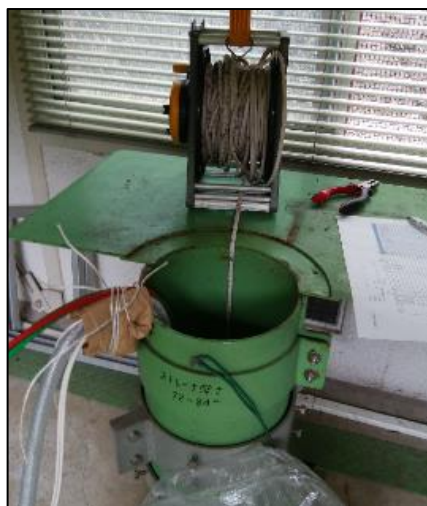
採水前後での井戸水位確認状況
