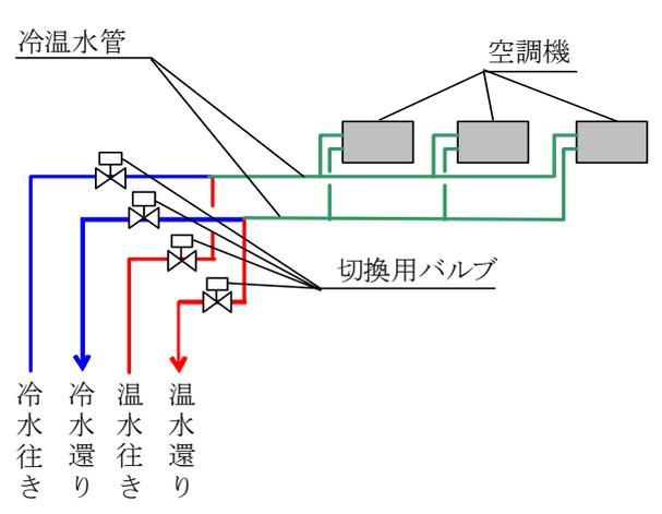
冷水・温水配管と切換用バルブ
