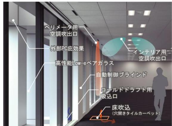
図 1:PC 架構造による外装構成
