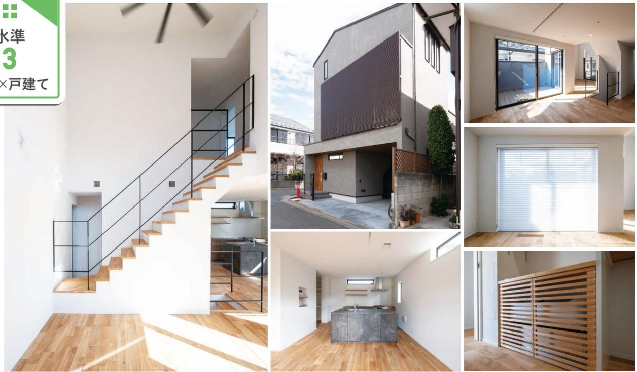
主な生活空間であるリビング・ダイニングを2階に配置したことで、バルコニーに面した南の窓から入る日射で室内は暖かく、冬はエアコンをつけると暑いほどの室温に。スクリーンを下ろせば日射を調整できます。リビングの上は吹き抜けになっており開放的な空間に
