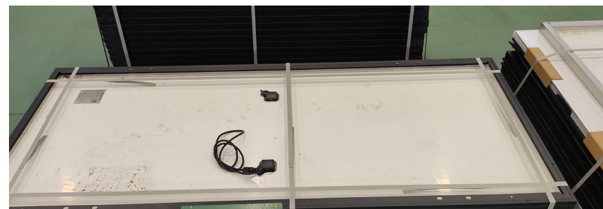
太陽光パネルの裏面とケーブル・コネクタ（提供：㈱浜田）
