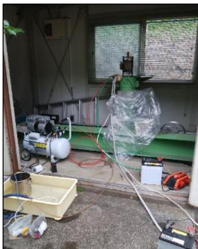
専用の器具を使った採水状況
