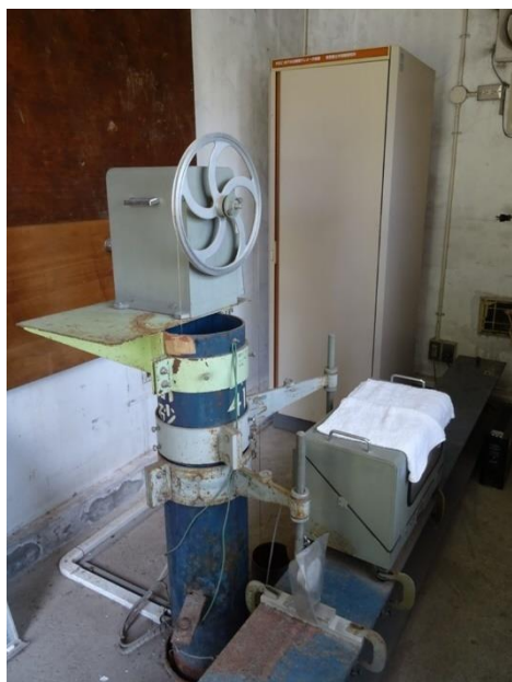
図 8-4 観測井の外観との模式図(単管式)
