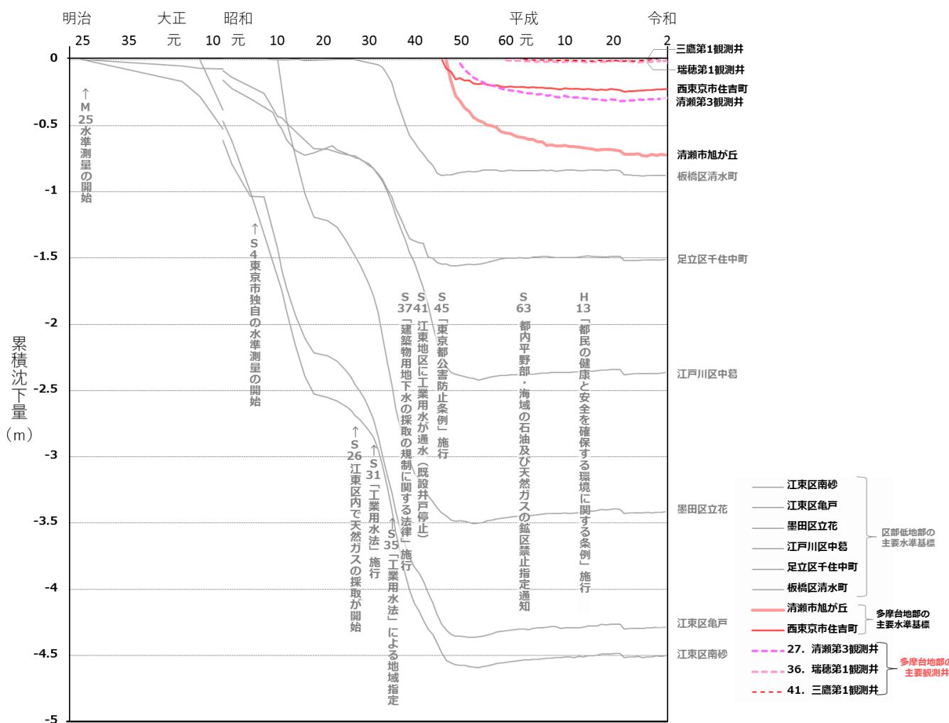
図 8-39 多摩台地部の主要観測井と主要水準基標の累積沈下量
