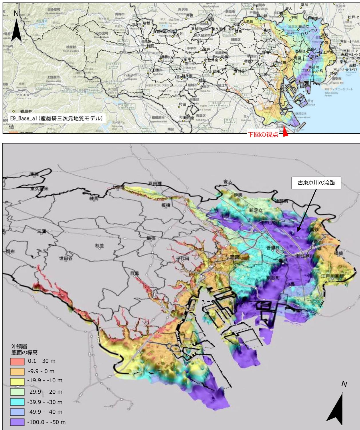
図 4-9 三次元地質モデルによる沖積層の底面形状
