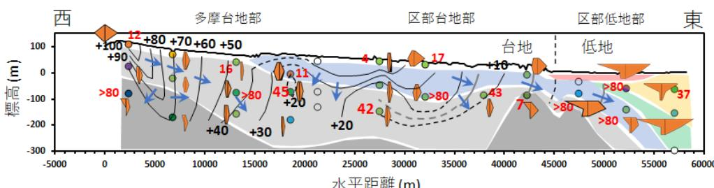
図 9-11 鉛直面で見た地下水の流動、水質組成、安定同位体比、滞留時間の分布
