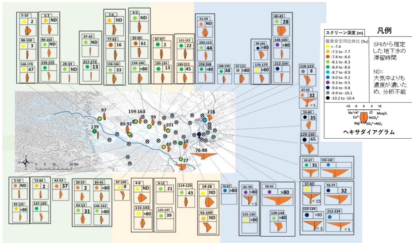
図 9-9 各観測井における溶存成分・安定同位体比分析および推定された地下水の滞留時間
