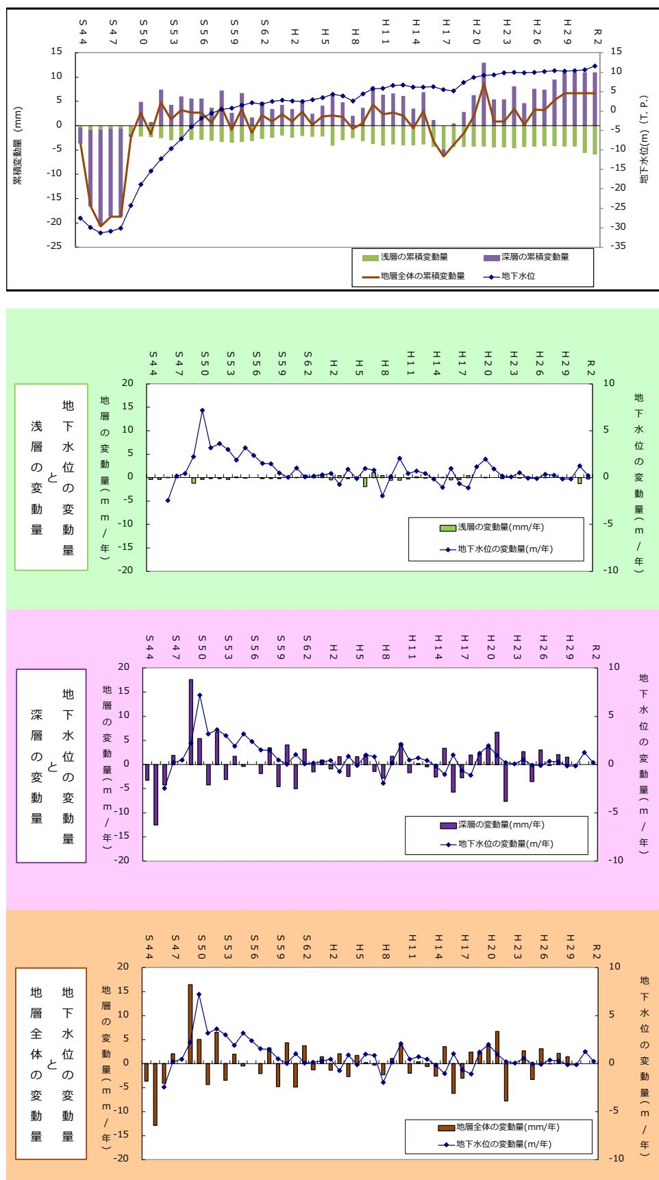
図 8-33 地盤と地下水位の推移(新宿区新宿観測井)
