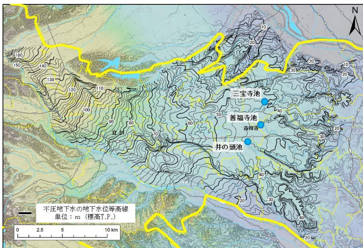
図5-5 武藏野台地における不圧地下水の地下水位等高線図 (S49.8月)
