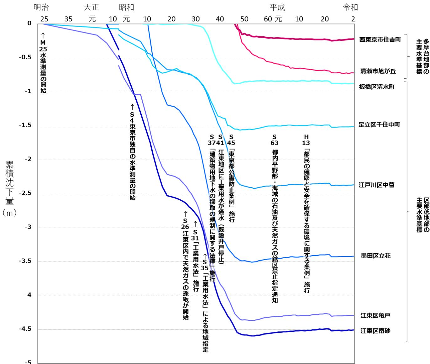
図 8-8 主要水準基標の累積沈下量
