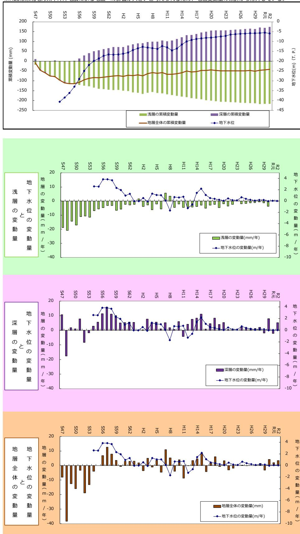
図 8-23 地盤と地下水位の推移(墨田区吾嬬 A 観測井)
