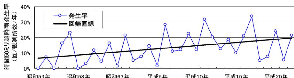
図2-4 時間50mmを超える降雨の発生率経年変化
