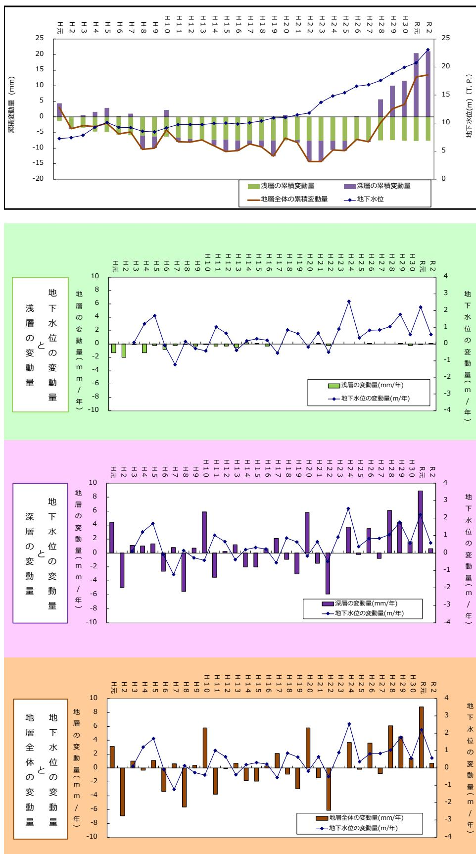
図 8-42 地盤と地下水位の推移(三鷹市三鷹第1観測井)
