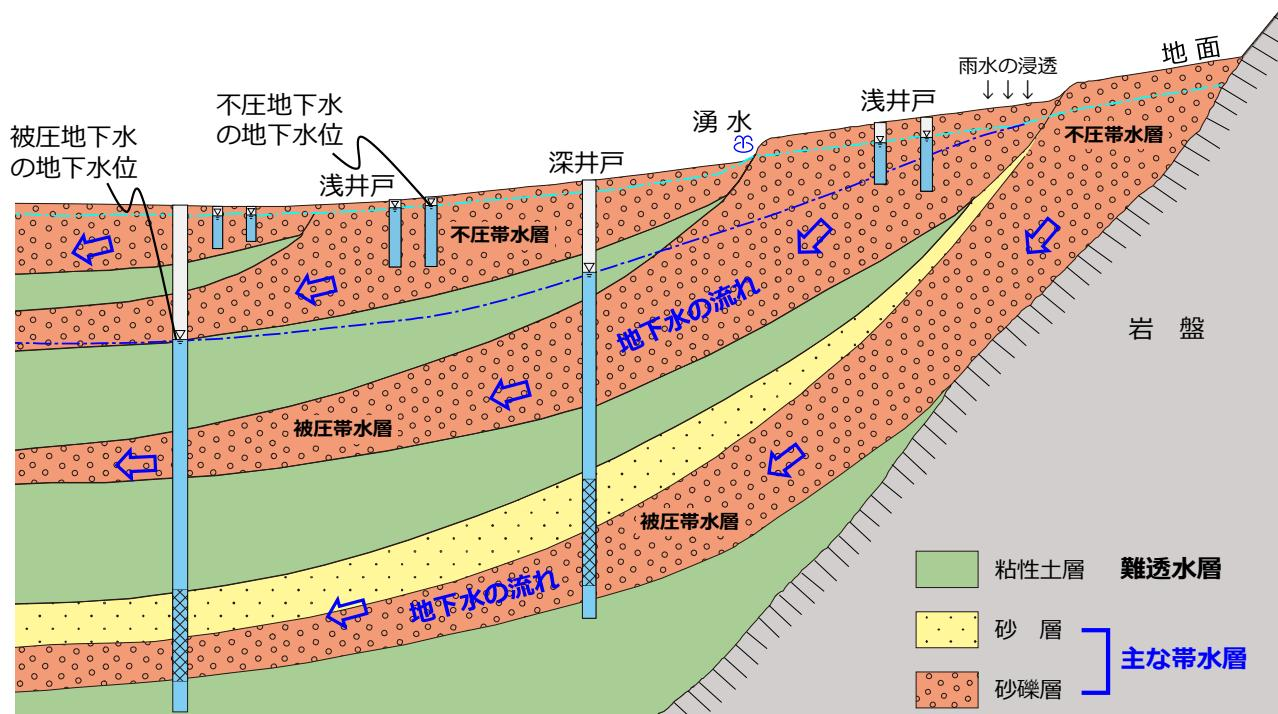
図 5-3 帯水層の地質構造と地下水流动の概念図
