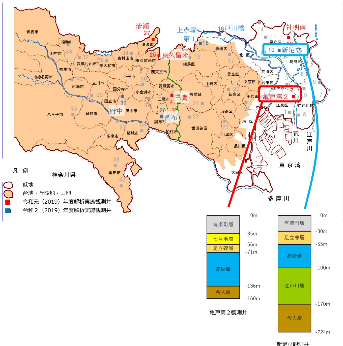
図 9-14 地盤情報の推定位置
