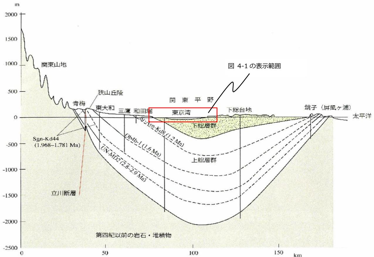
図4-2 関東平野中央部付近における東西断面図
