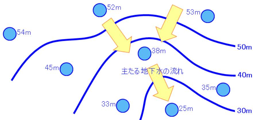
図 5-2 地下水位等高線から推定される地下水の流れ
