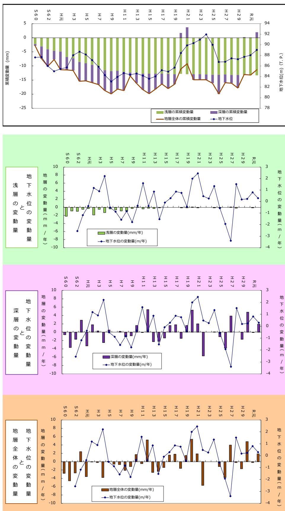
図 8-43 地盤と地下水位の推移(瑞穂町瑞穂第1観測井)
