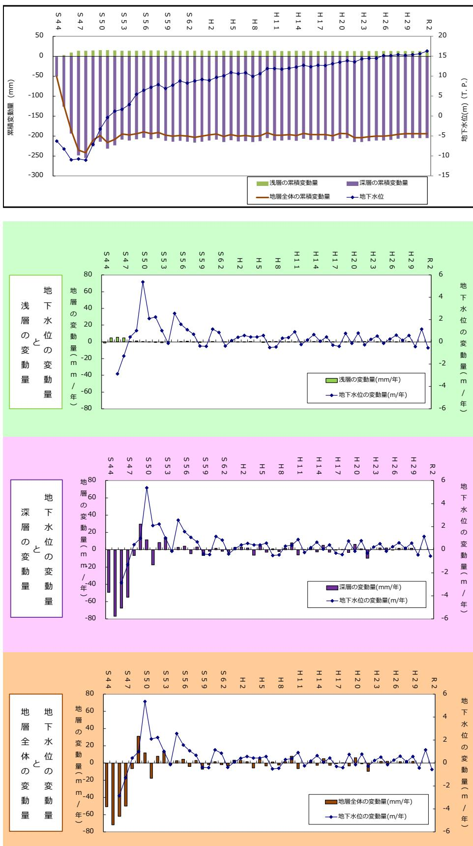
図 8-32 地盤と地下水位の推移(練馬区練馬第1観測井)
