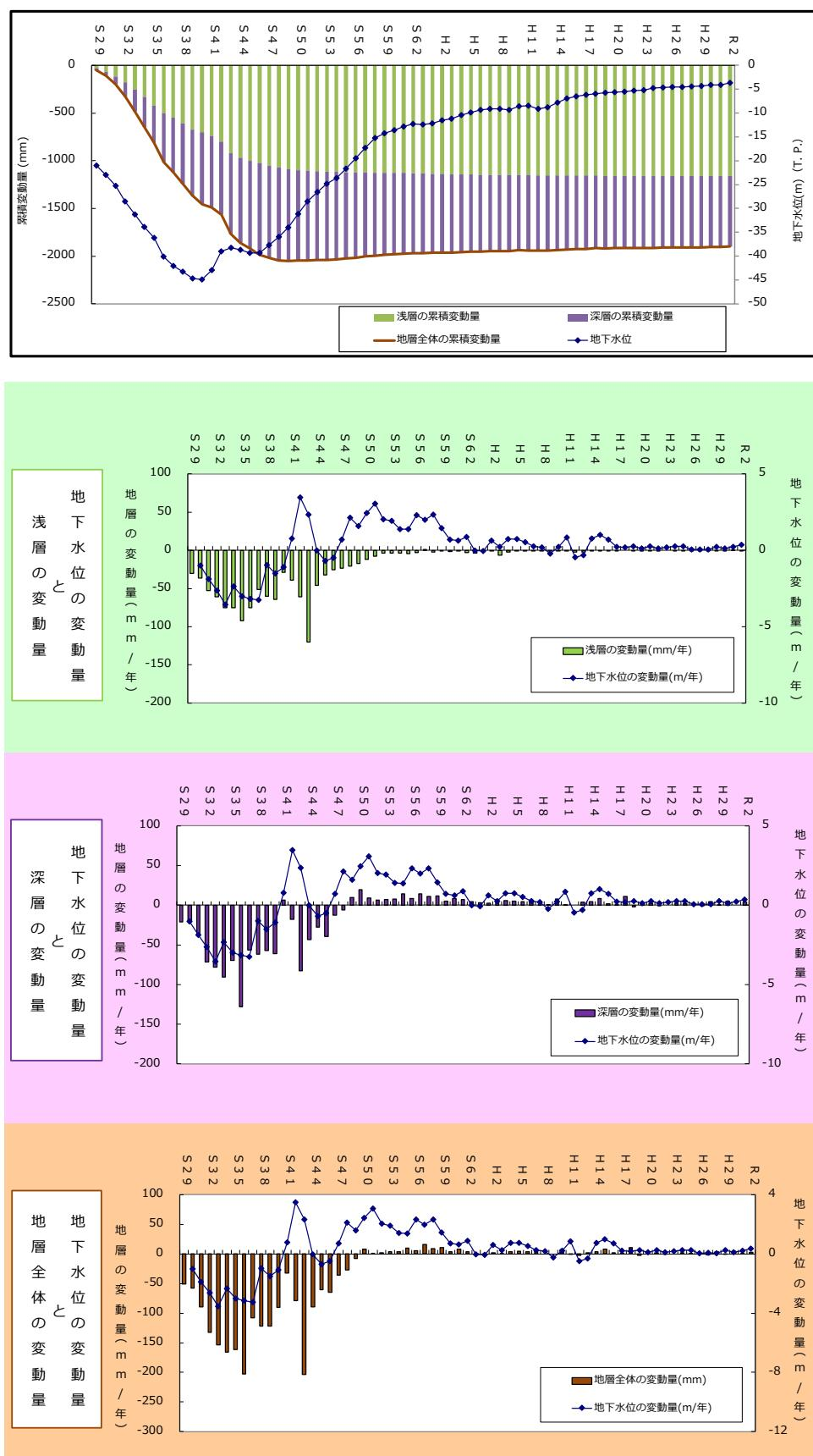
図 8-21 地盤と地下水位の推移(江東区亀戸第1観測井)【再掲】
