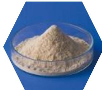
EDC-Mを注入すると、微生物が増殖・活性化し、その力で地下水に溶けた重金属が不溶化されます。
