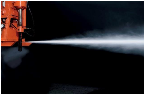
噴射ノズルにより、超高压ジェット噴流をよりシャープに噴射することで地盤を乱すことなく切削
