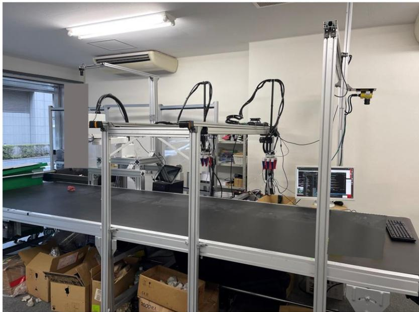
写真 4-2 アクチュエータ式ロボットアームの設置
