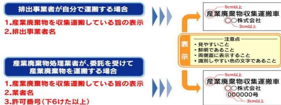
産業廃棄物の収集運搬車は、廃棄物処理法施行令に基づき、下記のような書面の備え付け(携帯)が義務付けられている。
