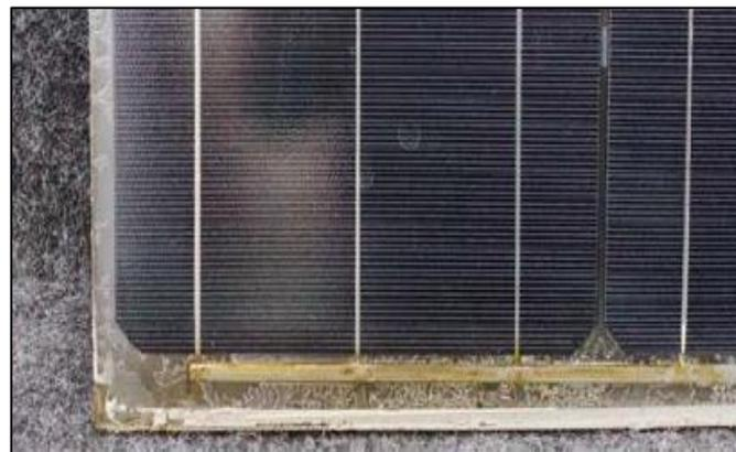
両面に分離後ガラスを使用したパネルに気泡発生
