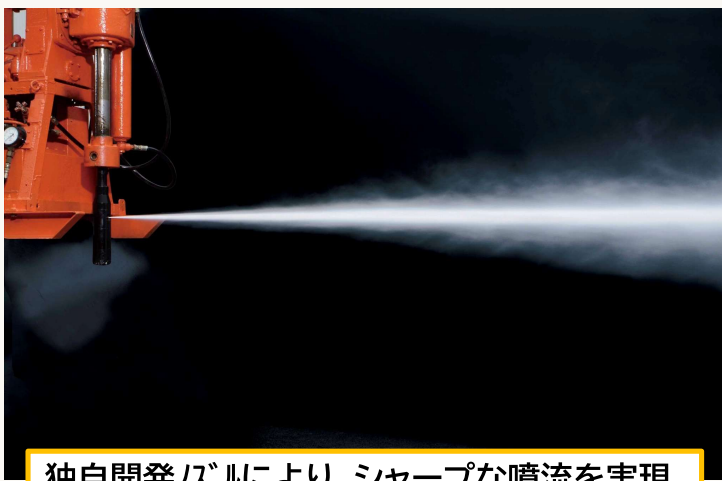
独自開発ノズルにより、シャープな噴流を実現
