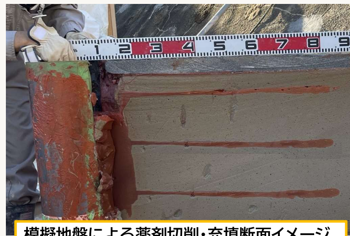
模擬地盤による薬剤切削・充填断面イメージ
