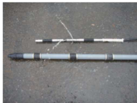
注入外管・内管からの送水状況
