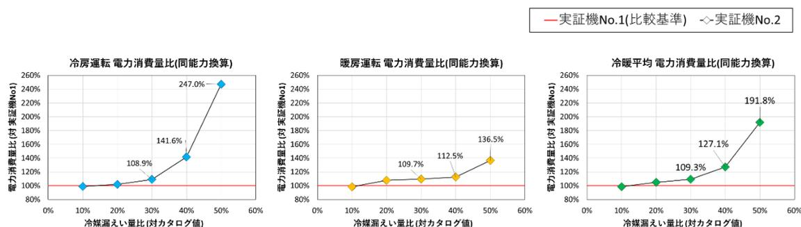
図 10. 電力消費量換算結果
