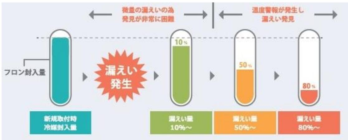
図2-1 漏えいによる冷凍設備の影響と漏えいに気付くタイミング
