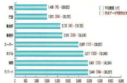
一次エネルギー消費原単位 [MJ/(m²·年)] 用途別一次エネルギー消費原単位
