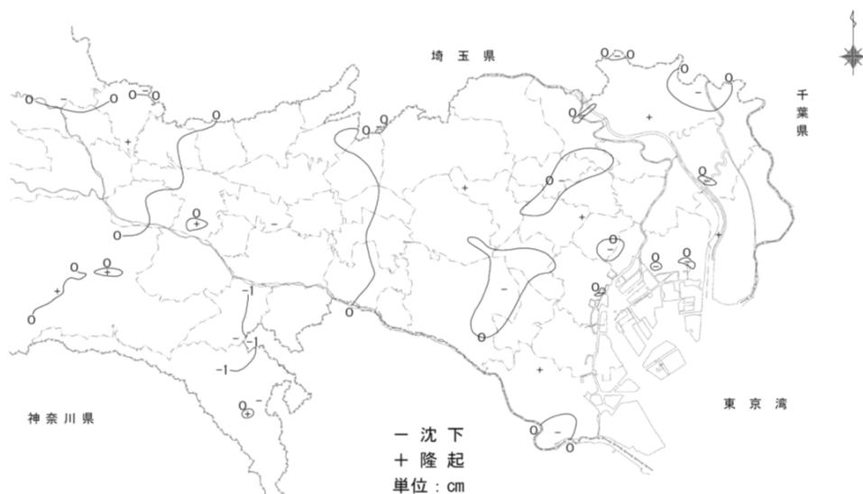
図5 令和3年の地盤変動量図
