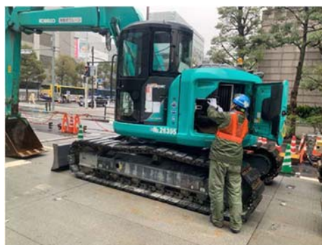
写真-2-1 建設機械の点検及び整備による性能維持（地点 01）
