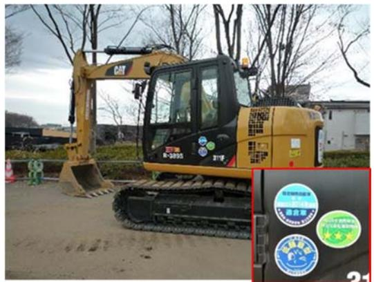
写真-6 低騒音型建設機械の採用（地点 03）
