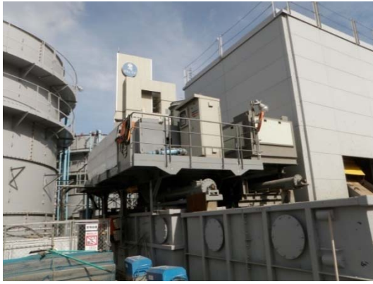
写真-1 建設汚泥の脱水処理の状況 (地点 02)
