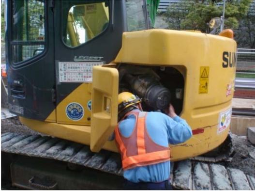
写真-2-1 建設機械の点検及び整備の状況
