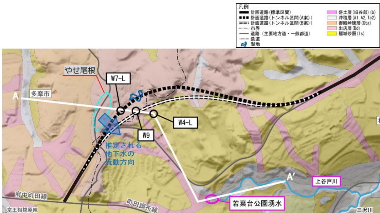
図 8.6-4 トンネル周辺の地形・地質概要 (平面)
