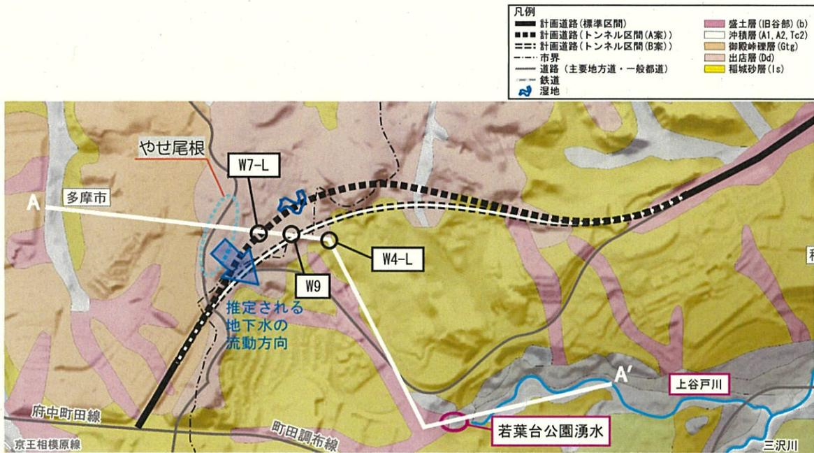
図 10.6-4 トンネル周辺の地形・地質概要 (平面)
