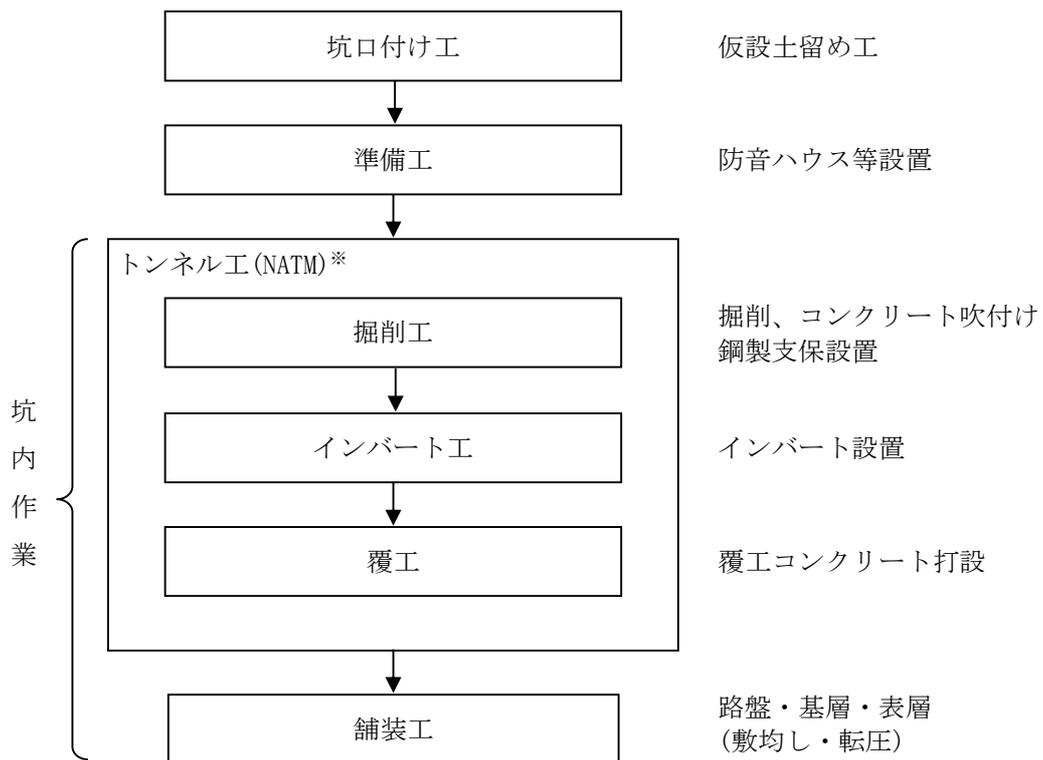
図6.2-4(3) 主な施工手順(トンネル構造)
