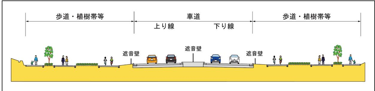
図6.2-3(1) 標準区間(平面構造)の道路断面例
