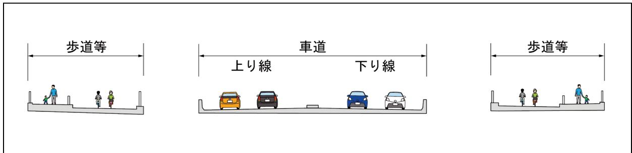
図6.2-3(2) 標準区間(橋梁構造)の道路断面例
