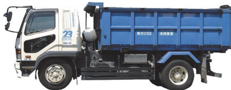
図 3.3-7 灰等運搬車両の外観（大型ダンプ車天蓋付 10m<sup>3</sup>）
