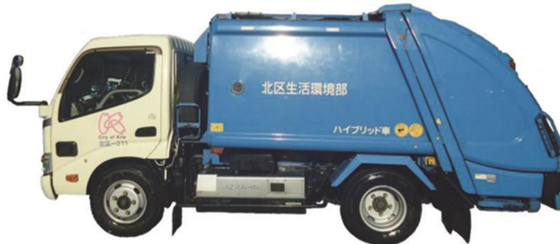
図 3.3-6 ごみ収集車両の外観（小型プレス車 4 m<sup>3</sup>）
