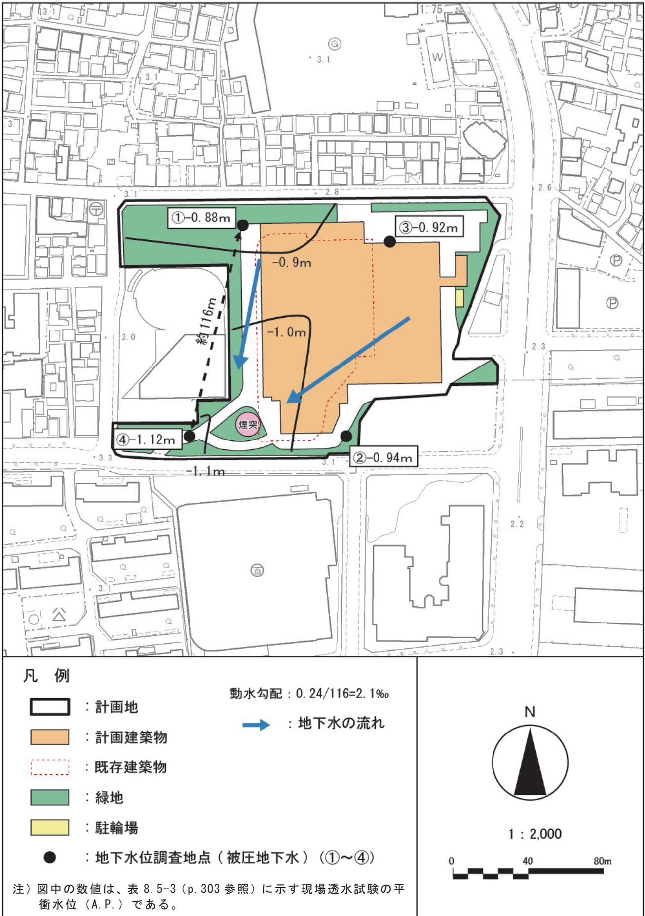
図 8.5-8(2) 計画地内の被圧地下水面図
