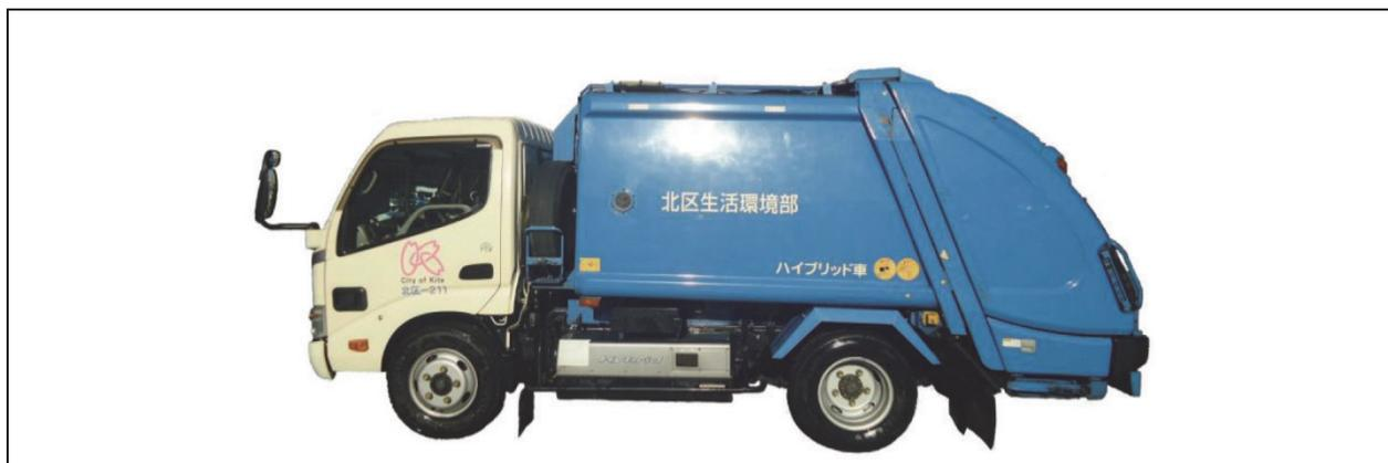
図 8.2-7 ごみ収集車両の外観（小型プレス車 4 m<sup>3</sup>）
