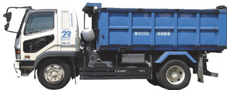
図6.3-7 灰等運搬車両の外観（大型ダンプ車天蓋付 10m<sup>3</sup>）
