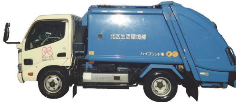
図6.3-6 ごみ収集車両の外観（小型プレス車 4 m<sup>3</sup>）
