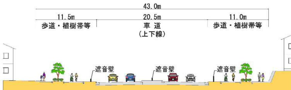
図3.3-1(1) 標準区間(平面構造)の道路断面例(図3.3-2(2)の④断面(14ページ参照))
