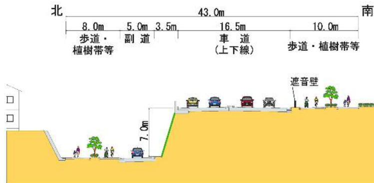
図3. 3-1(4) 鶴牧区間の道路断面例 (図3. 3-2(3)の②断面【将来】(15ページ参照))
