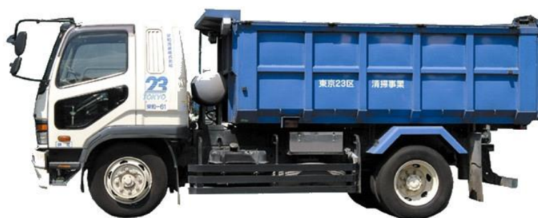
図 4.2.2-4 灰等運搬車両の外観（大型ダンプ車天蓋付 10m 3 ）
