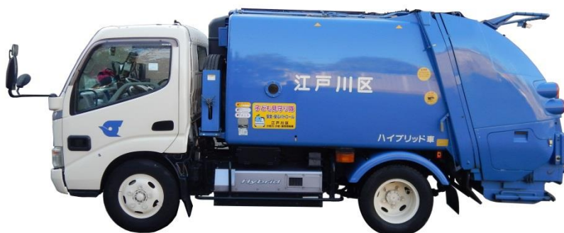
図 4.2.2-3 ごみ収集車両の外観（小型プレス車 4m 3 ）
