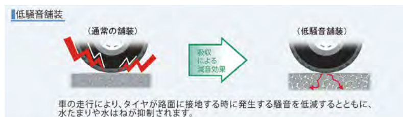
図 8.2-12 低騒音舗装による低減効果イメージ
