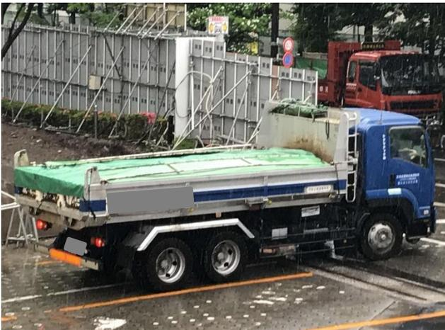
写真7 工事用車両の粉じん飛散防止対策
