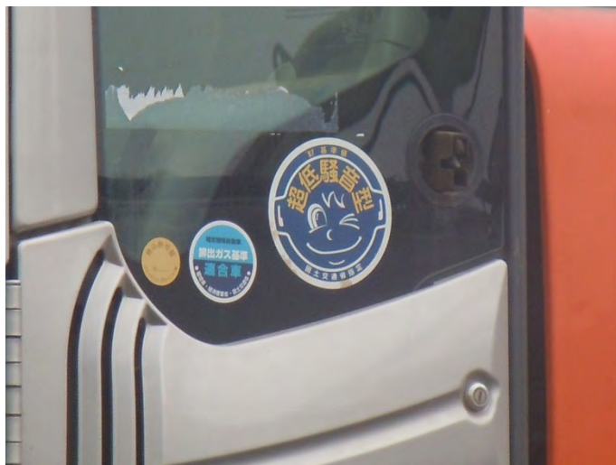
写真 2-7(2) 低騒音型の機械（バックホウ ZAXIS120）（拡大）
