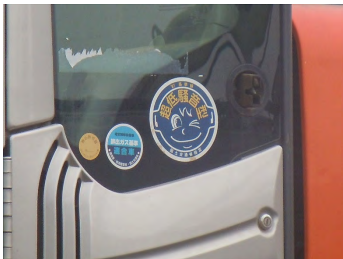
写真 1-5 (2) 排出ガス対策型の機械（バックホウ ZAXIS120）（拡大）
