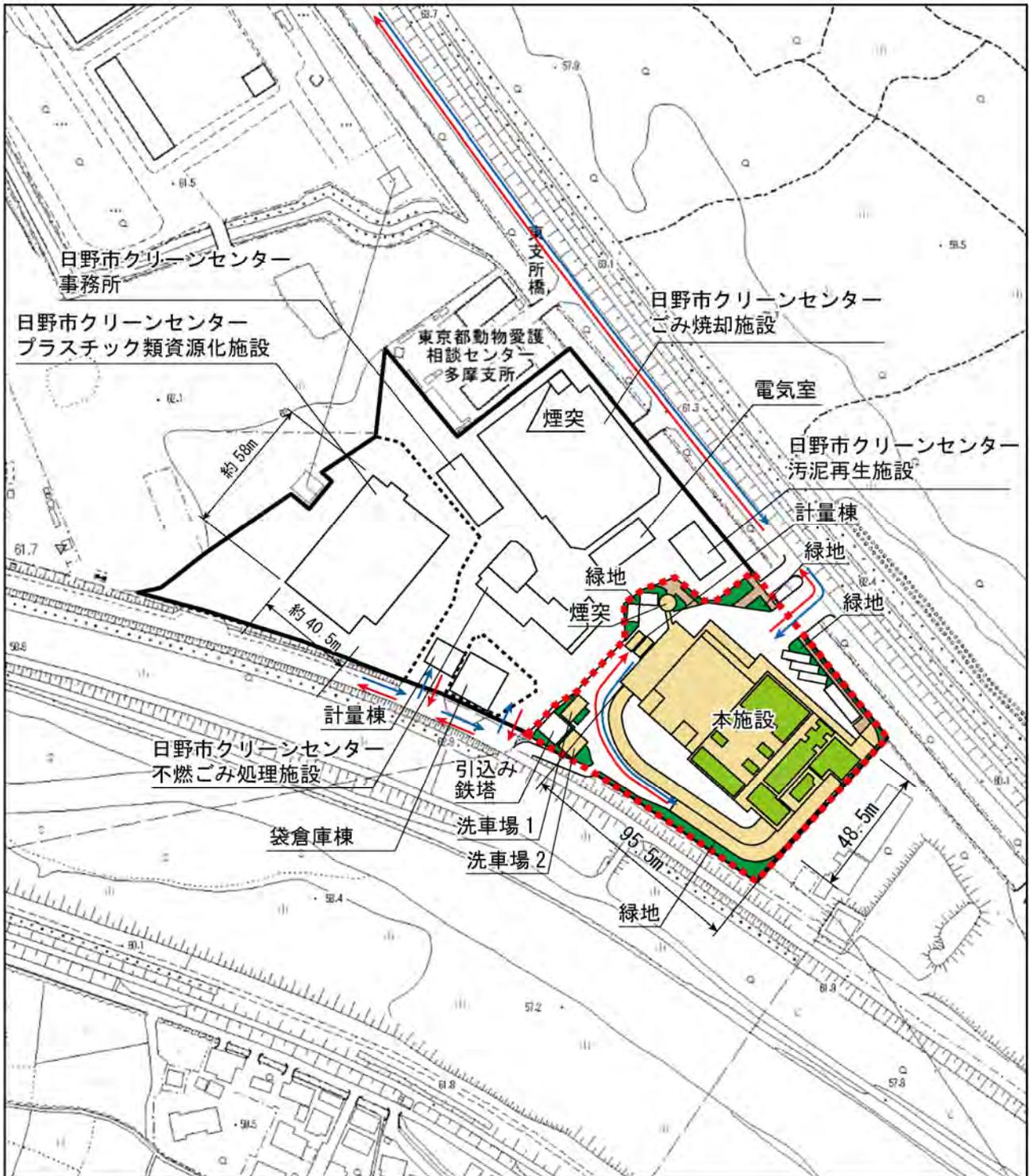
図-2 施設配置図（本施設建設後）
