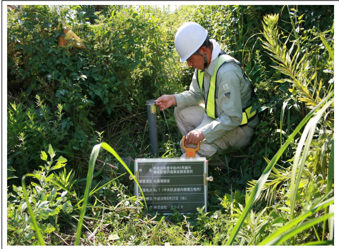
写真 5-5 (1) 地下水位観測状況 (中防内)
