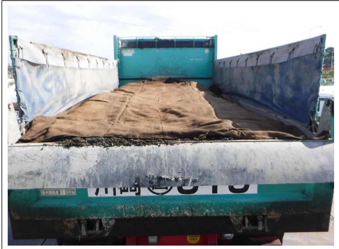
写真 4-1(1) 粉じん飛散対策（防塵シート）
