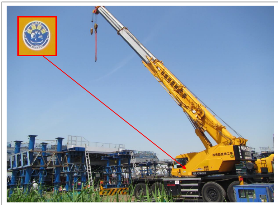
写真 2-1(2) 低騒音型建設機械（ホイールクレーン KR-70H-L）
