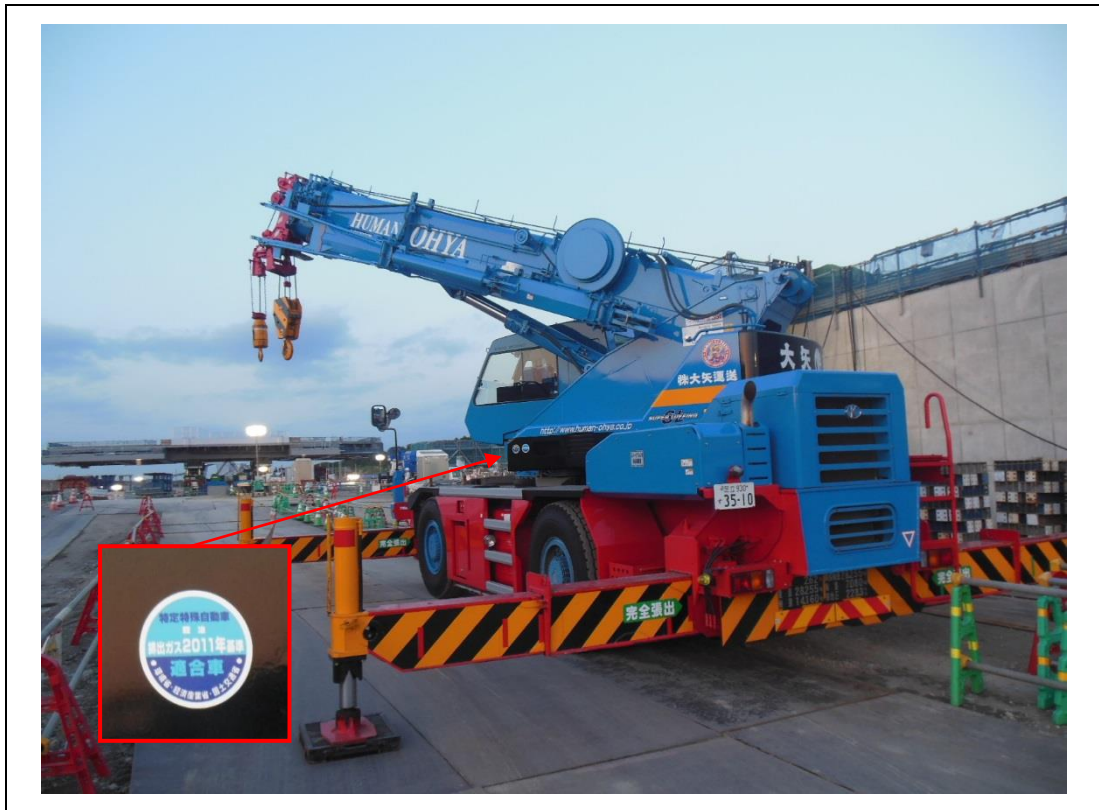
写真 1-1(1) 排出ガス対策型建設機械（ホイールクレーン KRM-35H-II）
