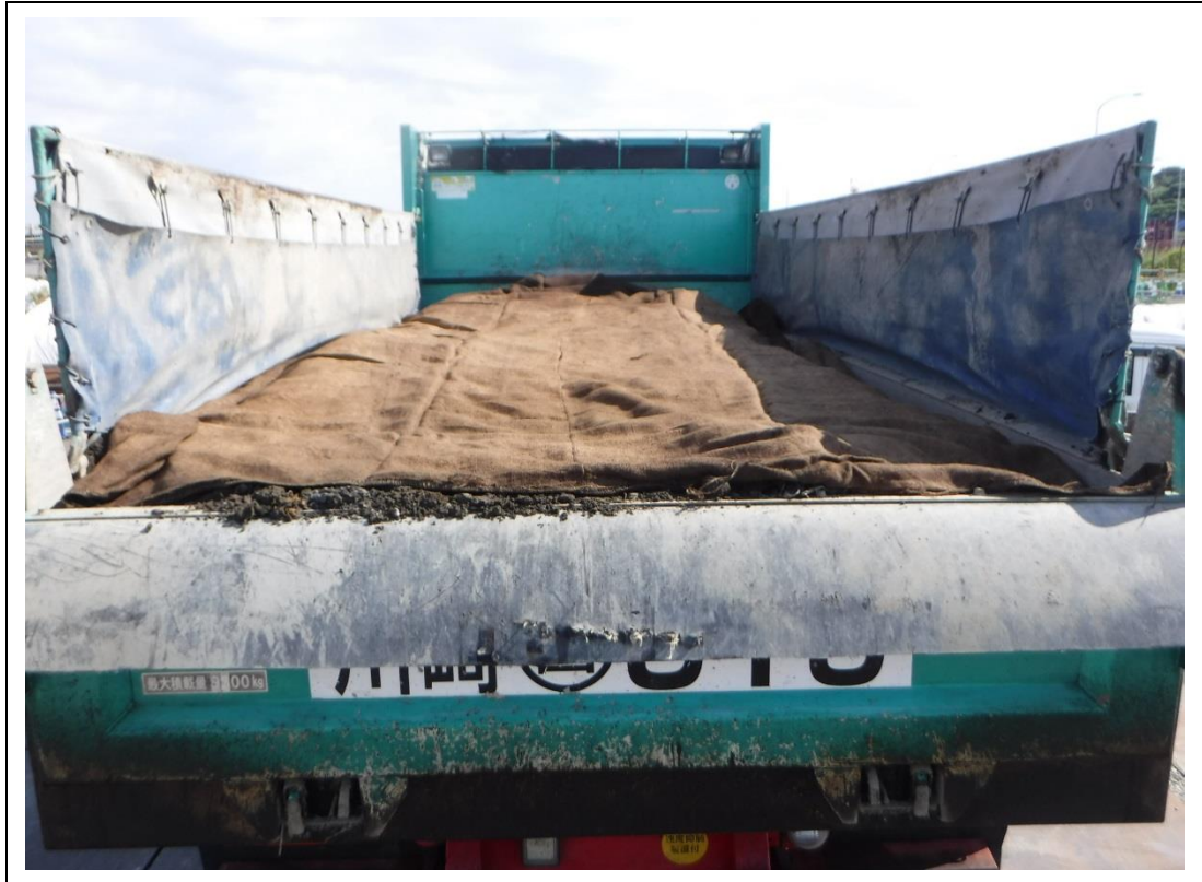
写真 1-4 粉じん飛散防止対策（防塵シート）
