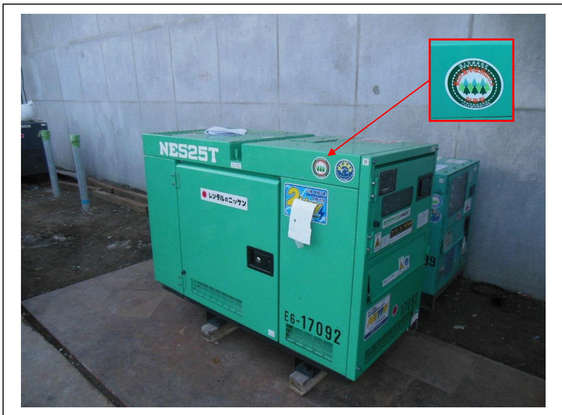
写真 1-1 (4) 排出ガス対策型建設機械（発電機 NES25TK）
