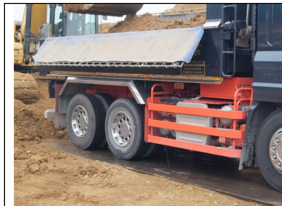
自動開閉シート（開状態） （平成31年1月）
