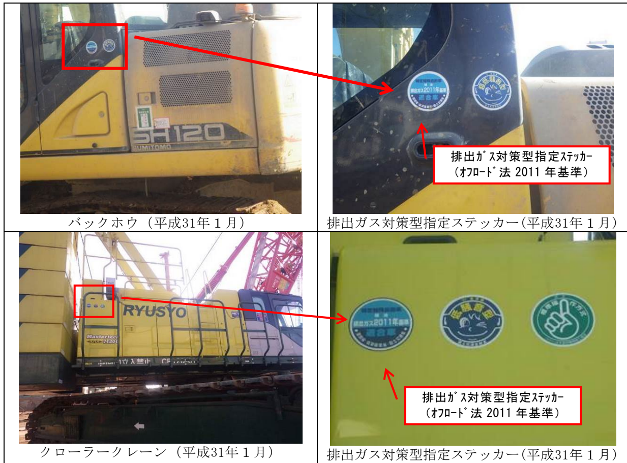
写真7-(1) 排出ガス対策型建設機械の採用状況
