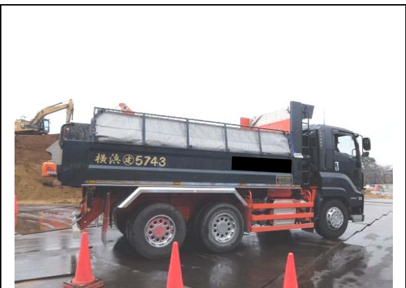
自動開閉シート（閉状態） （平成31年1月）
