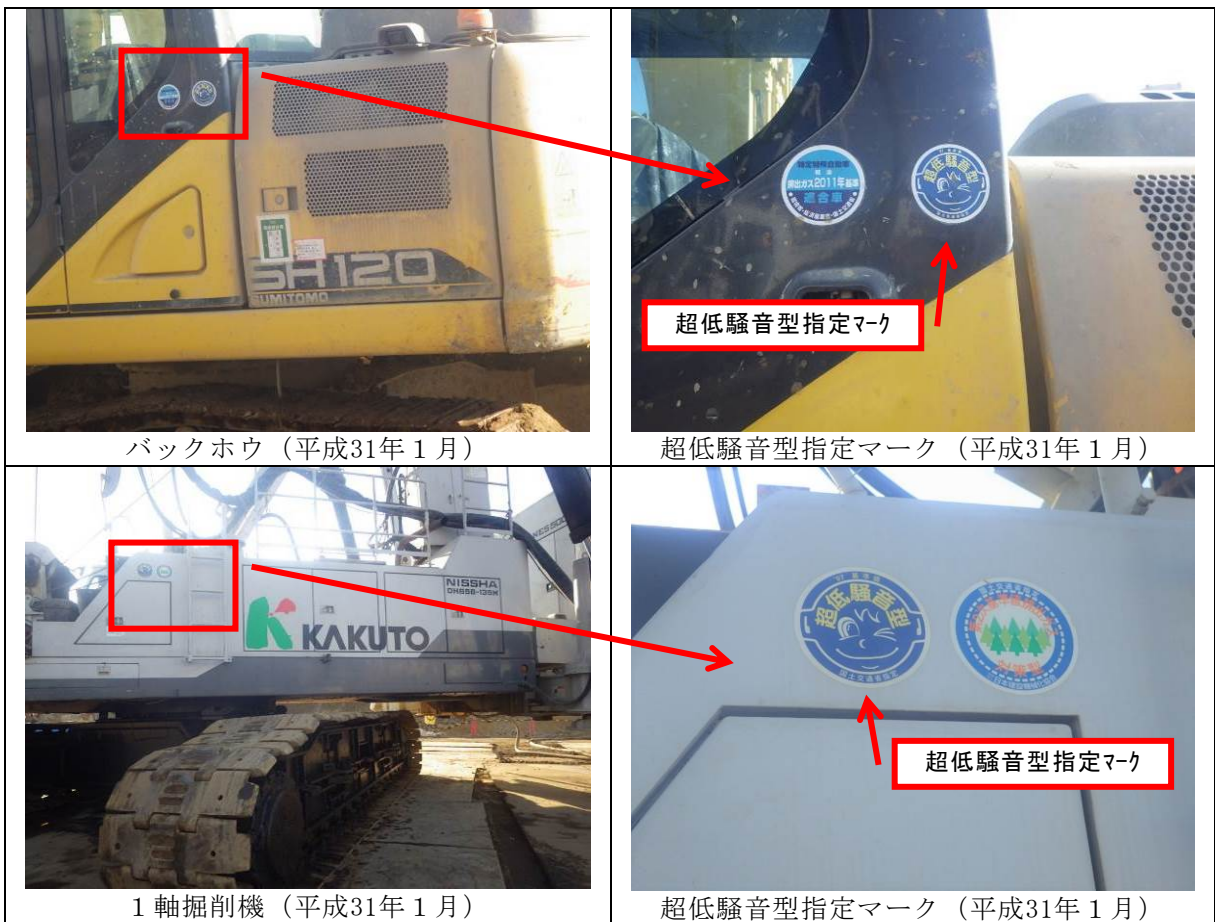
写真1-(1) 低騒音型建設機械の採用状況
