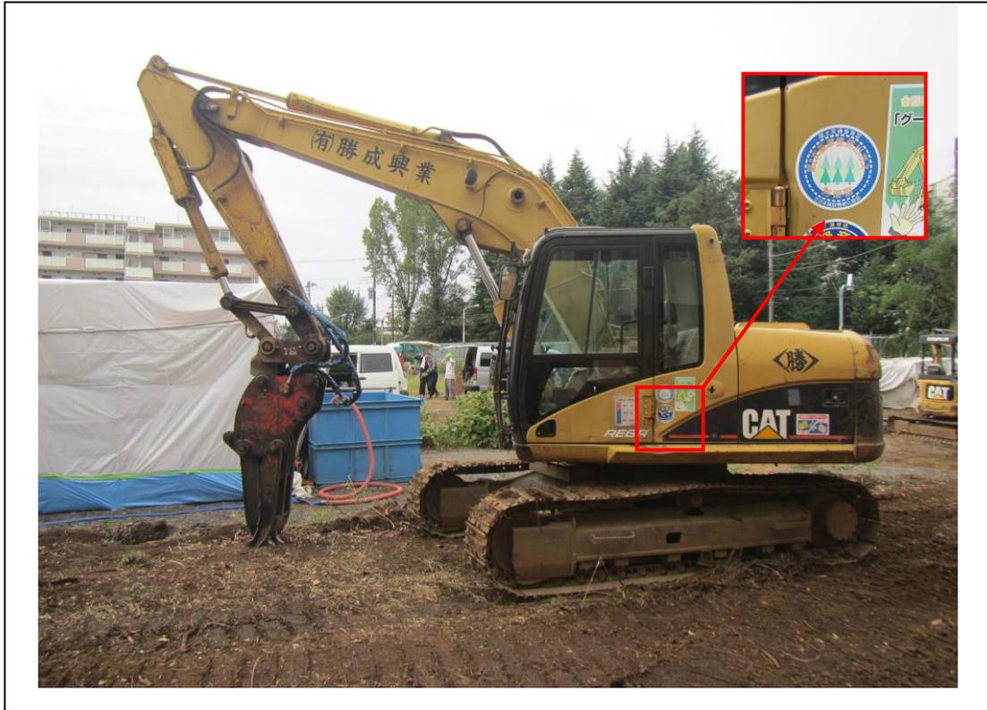
写真 1-1 (1) 排出ガス対策型建設機械の使用状況【除却】：躯体解体[油圧破碎機]
