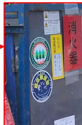
写真 2-3 超低騒音型建設機械 (発電機)
