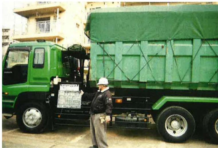
写真 1-4 搬出車両の荷台のシート設置状況
