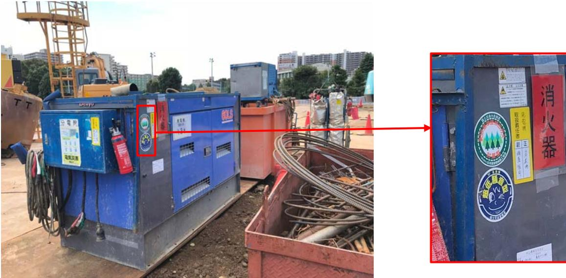
写真 1-2 排出ガス対策型建設機械の使用状況(発電機)
