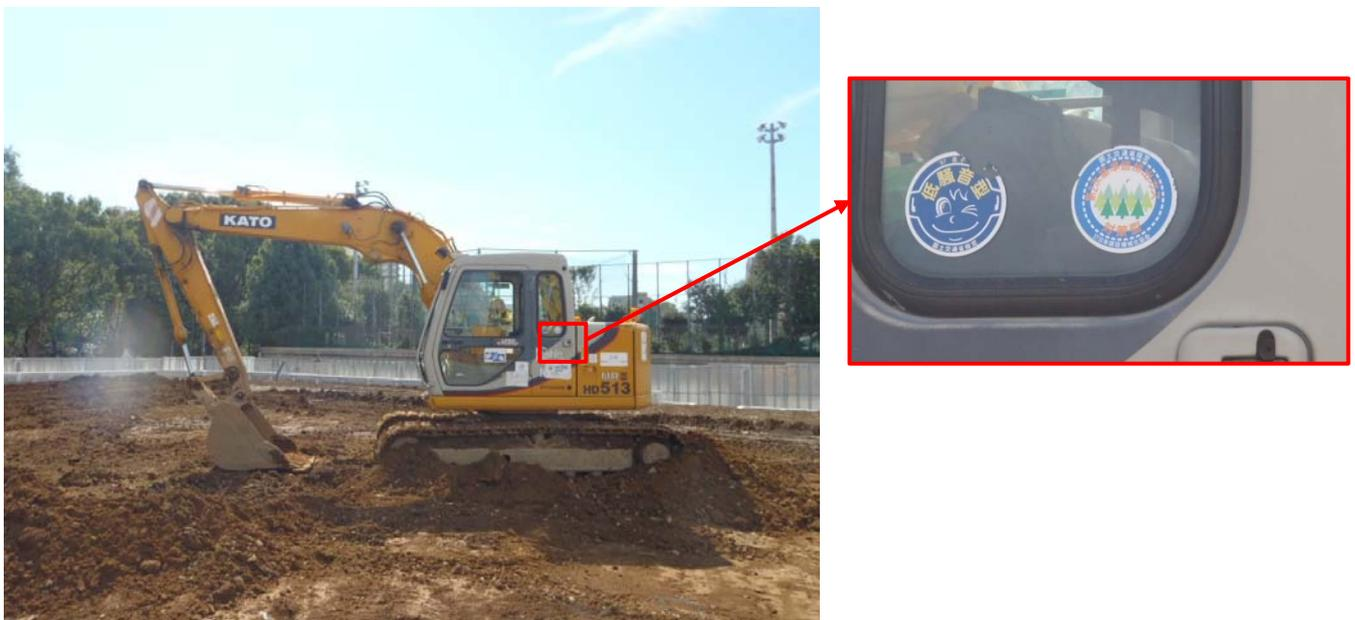
写真 1-1 排出ガス対策型建設機械の使用状況 (油圧ショベル)
